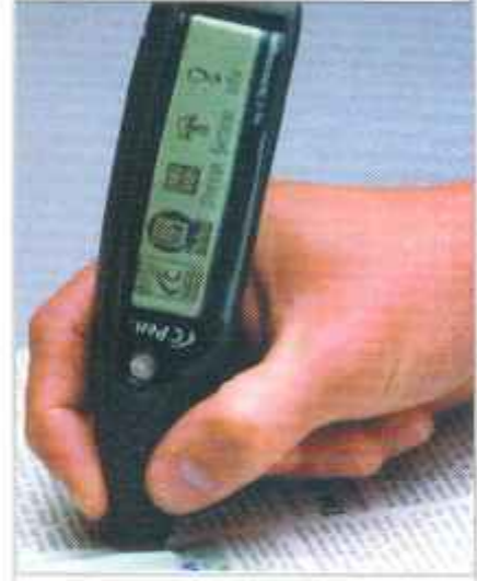
TARAYICI KALEM; Taranan metinler veya grafikler hafızaya alınıp farklı ortamlara iletilebiliyor.
